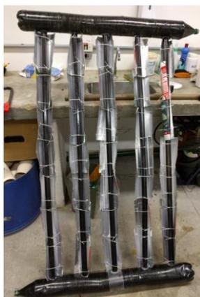
As caixas TETRA PAK™ foram cortadas na vertical e divididas em duas partes para serem posteriormente coladas com cola quente nos suportes de garrafas pet com sua parte espelhada (interna) voltadas para os tubos de PVC a fim de refletirem os raios solares e aquecer a água com a maior eficiência possível.
