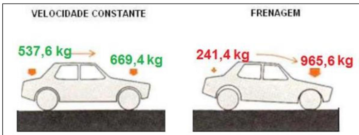
Portanto numa situação de frenagem, o Grand Siena Tetrafuel transfere aproximadamente 296,2 kg para a suspensão dianteira, podendo assim causar um maior desgaste aos componentes desse sistema.
