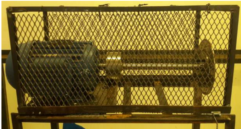
Figura 5. Estrutura de proteção desenvolvida para a bancada, vista superior
