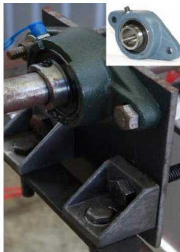
Figura 8. Suporte de mancal acoplado na estrutura, e respectivo mancal FL 205
