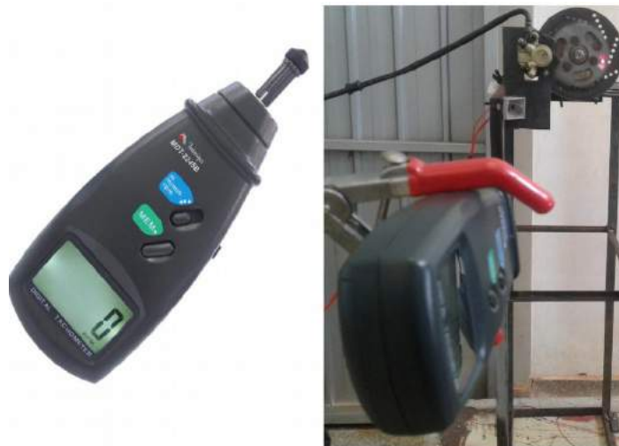
Figura 5. Tacômetro MDT-2245B MINIPA utilizado para controle de rotações
