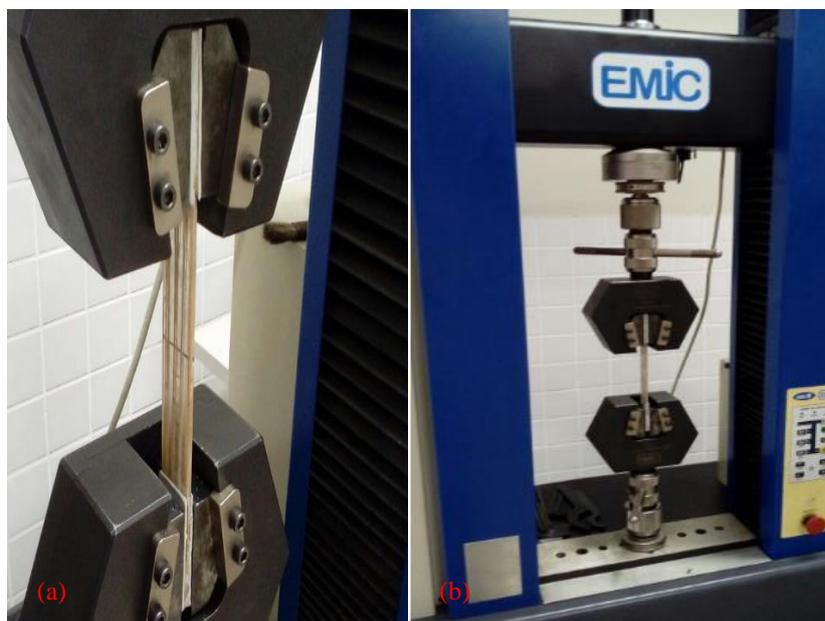
Ao fim do ensaio de tração os dados foram coletados para análise assim como as partes dos corpos de prova para que pudesse ser feita a análise no local da falha visando determinar possíveis características da falha e de como ela ocorreu, enriquecendo ainda mais a presente investigação.
