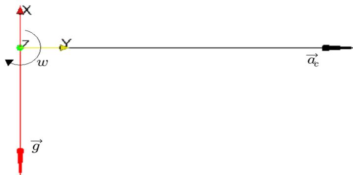
Para o segundo caso, foi acrescentado uma componente de aceleração centrífuga ( $a_c$ ). Ela possui um vetor na direção longitudinal da pá e é dada pelo produto do quadrado da velocidade angular e o raio (Halliday, 1996).
