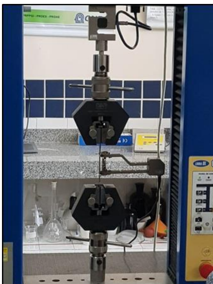
Figura 2. Ensaio de tração sem extensômetro externo (Fonte: Autor)
