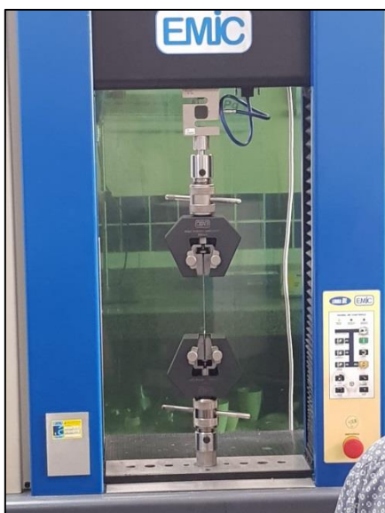
Figura 2. Ensaio de tração sem extensômetro externo (Fonte: Autor)
