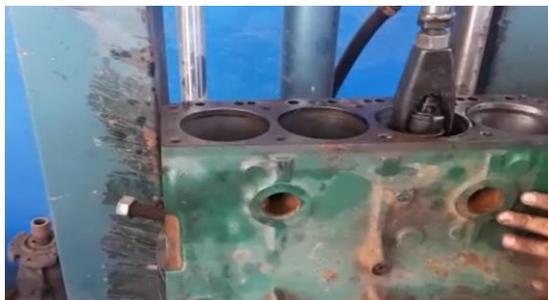
O pistão ao descer do ponto morto superior para o inferior varre um volume que representa um cilindro cuja base é a sua secção e a altura é o caminho do pistão, denominado como volume varrido ou cilindrada. À soma dos volumes varridos de todos os cilindros dá-se o nome de cilindrada do motor. Se um motor tiver um número  $n$  de cilindros com um diâmetro  $d$  e curso  $C$ , a sua cilindrada pode ser obtida através da seguinte equação (MARTINS, 2013).
