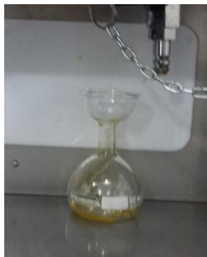
Figura 2. Experimento para encontrar a viscosidade do óleo de mamona (Próprio autor, 2019)
