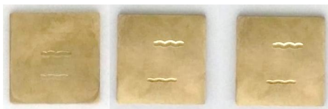
Figura 4. Corpos de prova depois dos experimentos com óleo de mamona, desgaste superior 60N e inferior 30N (Próprio autor, 2019)
