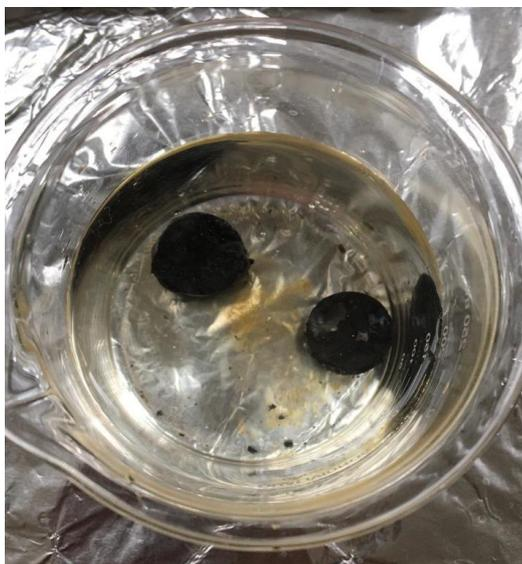
Figura 4. Amostra Termodifundida após a Remoção do Sal (Próprio Autor, 2019)
