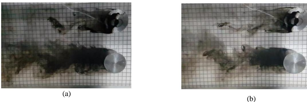
Figura 6. Comportamento das esteiras turbulentas para ambos cilindros superior e inferior como isolado, em diferentes instantes: (a) e (b).
