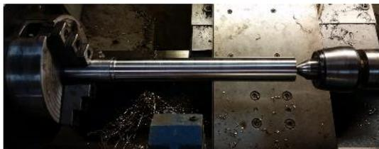
Dois corpos de prova foram preparados, um com cada ferramenta de corte, cada um sendo dividido em 12 amostras com ranhuras de 2 mm, a cada 18 mm no comprimento da barra, como mostra a Figura 3. O uso de 12 amostras em cada corpo de prova é justificado pelo fato de permitir maior facilidade na combinação dos diferentes parâmetros de usinagem utilizados.
