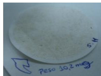
Figura 9: Contaminantes saída hidrociclone
