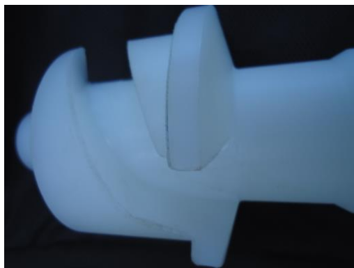
Figura 2 – Peça motriz do hidrociclone (Machsystem® [2]).
