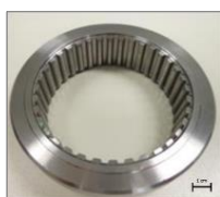
Figura 2. Amostra após brochamento do perfil interno
