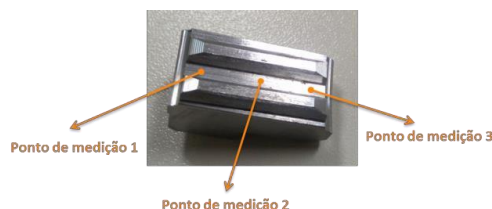
Figura 5. Medição de tensão residual na etapa de controle 1
