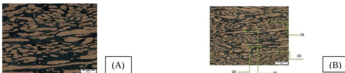
Figura 7. (A) Amostra com controle de temperatura ZTA final (50x) ataque Behara. (B) Amostra com controle de temperatura ZTA final (100x), ataque Behara.
