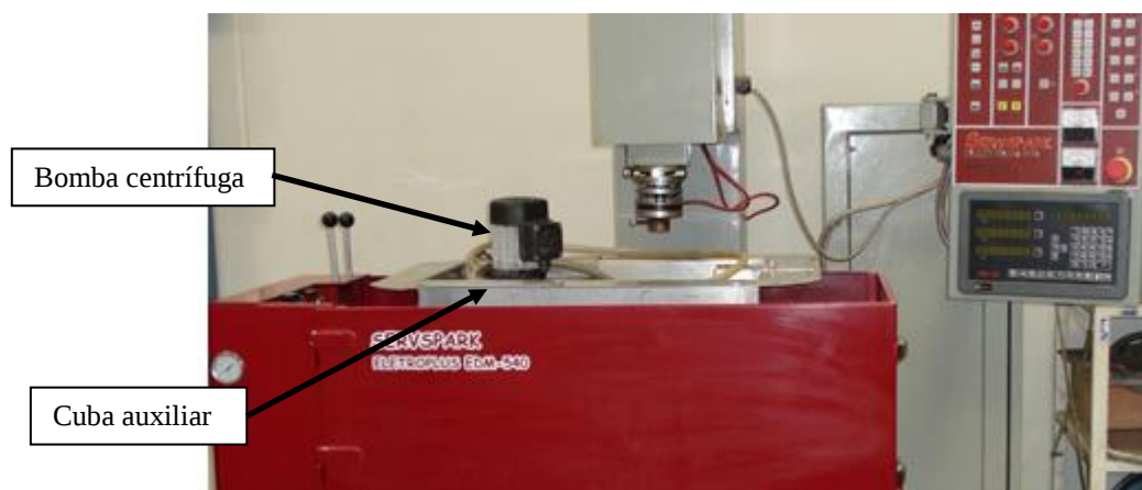
Figura 1. Eletroerosão por penetração adaptada para aplicação do processo de nitretação por descargas elétricas
