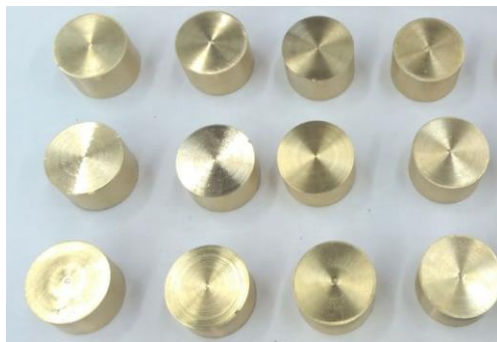
Figura 1. Amostras cortadas de latão C-360.
