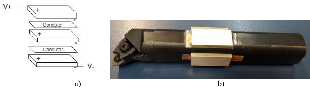
Figura 1 – Montagem dos atuadores piezelétricos multicamadas a) esquema; b) montagem experimental
