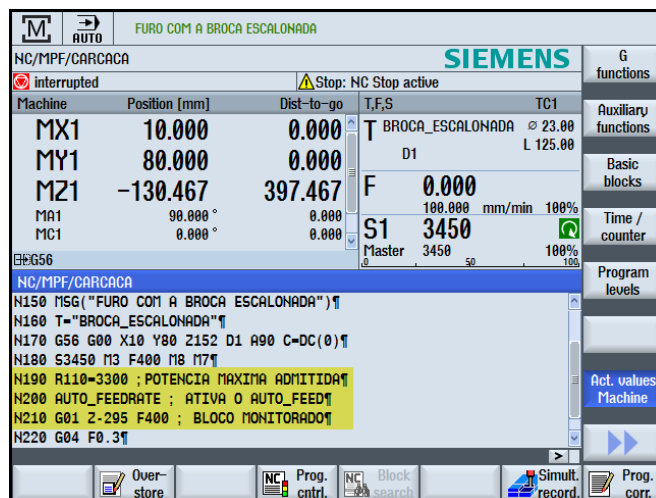
Figura 2 - Disposição da rotina no programa de usinagem
