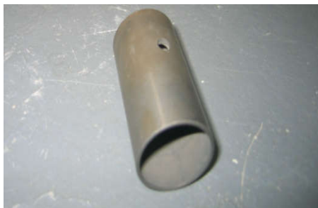
Figura 1. Amostra de tucho mecânico utilizado no estudo (Autores, 2019)
