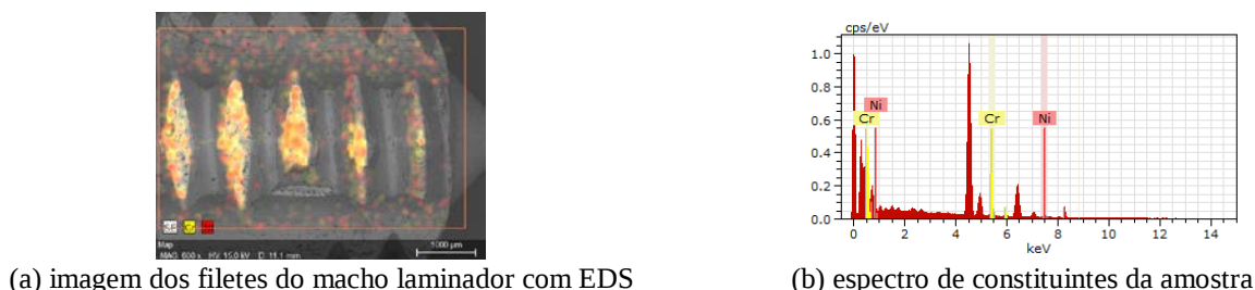
Figura 6. EDS do macho laminador (Fonte: Autoria própria)
