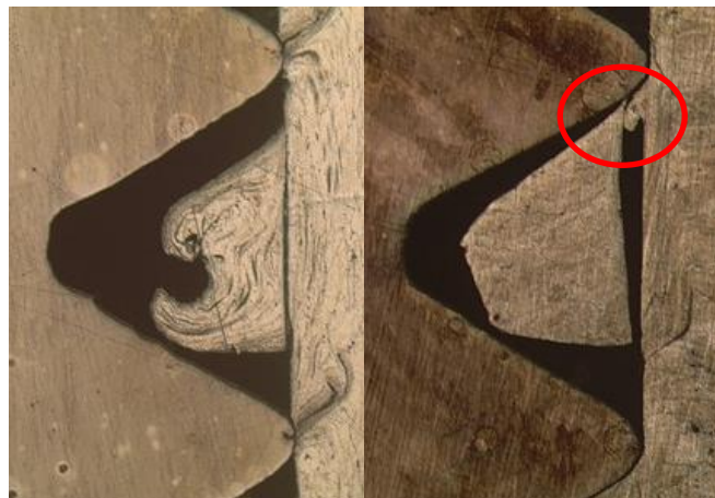
Figura 5 – Comparação entre os filetes laminados e usinados, destaque para a rebarba deixada pelo filete anterior no processo de usinagem.
