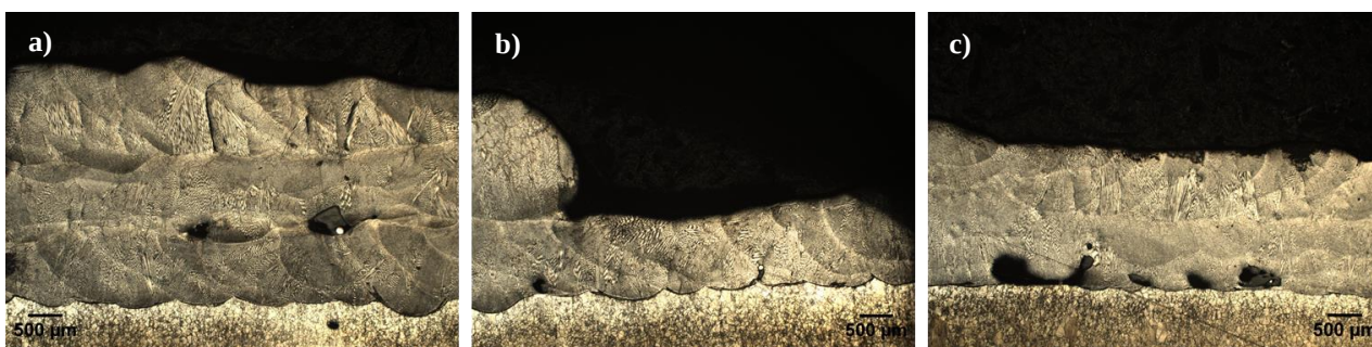
Figura 4 – Análise microestrutural das camadas depositadas por fusão seletiva a laser, com 70% de resolução. a) Região com 3 camadas depositadas; b) região com 1 camada depositada; c) região com 2 camadas depositadas.
