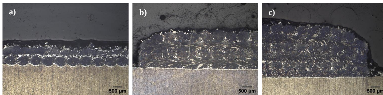
Figura 5 – Análise microestrutural das camadas depositadas por deposição direta de energia: a) amostra com 1 camada depositada; b) amostra com 2 camadas depositadas; c) amostra com 3 camadas depositadas.
