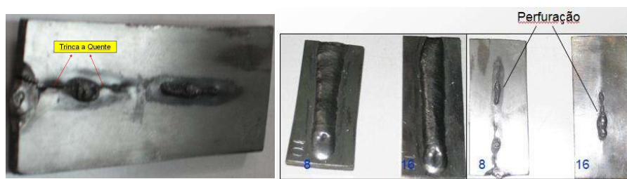
Figura 1. Trinca de solidificação longitudinal do AISI 304 soldado com o arame tubular AWS E316LT-4, com H = 805 \text{ J/mm} .
