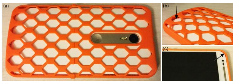
Figura 5. Em (a) capa montada no celular, em (b) e (c) detalhes das folgas no encaixe (Autor)
