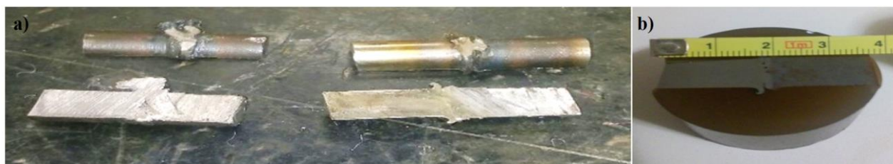
Figura 1 – a) Juntas soldadas seccionadas; b) Amostra embutida para ensaio metalográfico.
