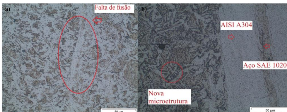
Figura 2 – Micrografia das regiões soldadas formadas por juntas de a) materiais similares e b) materiais dissimilares.
