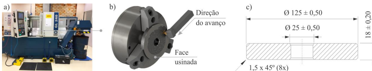
Figura 2. a) Torno CNC Romi GL-240, b) sistema de fixação, e c) corpo de prova
