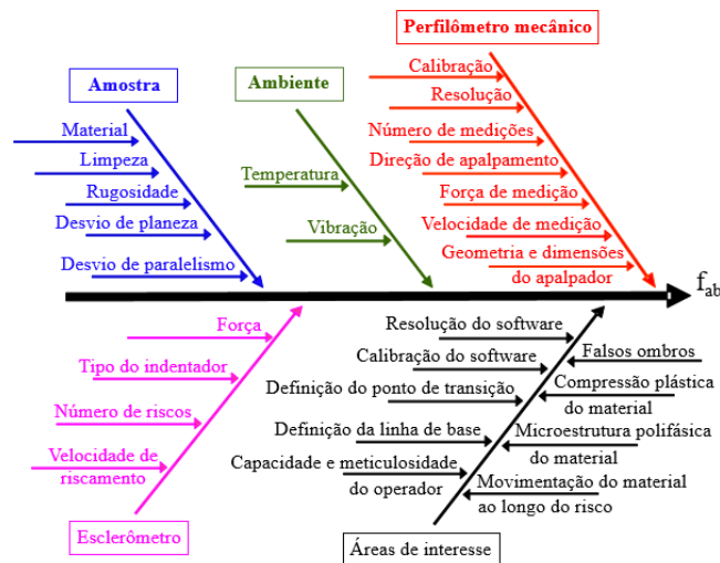
Figura 3. Diagrama de causa e efeito, com os principais fatores e fontes de erros observadas na determinação do fator f_{ab} utilizando perfilômetro mecânico (medição com contato).
