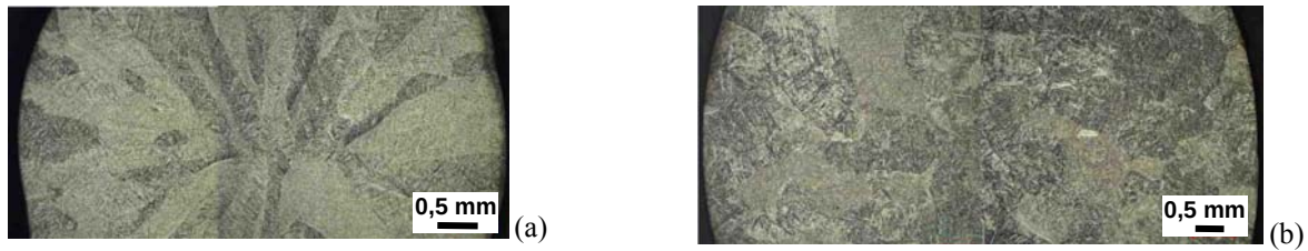
Figura 3. Macroestrutura ótica obtidas com luz polarizada de amostras da liga Ti-6Al-4V solidificadas em molde de cobre cilíndrico de: (a) 6 mm e (b) 10 mm de diâmetro.
