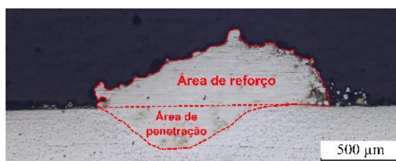
Figura 1. Exemplo de medição da diluição geométrica de uma seção transversal de um cordão.
