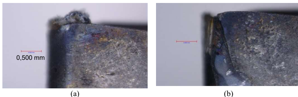
Figura 4. (a) Desgaste de flanco e adesão de material na aresta, observado no 3º passe do ensaio principal (12 s); (b) fratura na aresta, observada no 4º passe da réplica (16 s)
