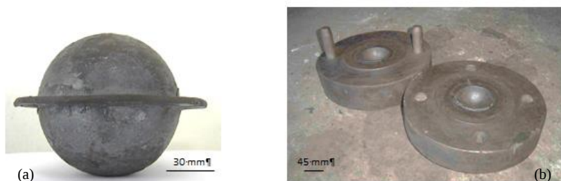
Figura 1. (a) Corpo moedor forjado com rebarba e (b) matrizes de forjamento a quente.
