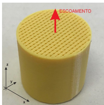
Figura 2. Meio poroso fabricado por extrusão de material
