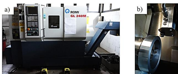
Figura 1. a) Centro de torneamento Romi® GL 240M; b) Detalhes do corpo de prova, do dinamômetro e da ferramenta
