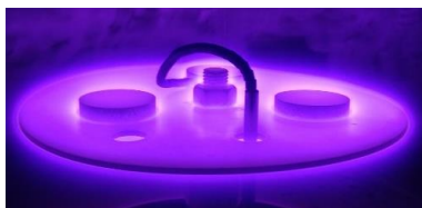
Figura 2. Amostras durante o tratamento de nitretação a plasma
