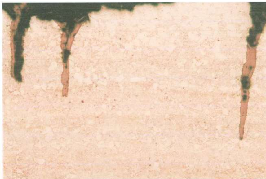
Figura 11: Micrografia da superfície interna, apresentando trincas transgranulares, retilíneas e paralelas. Aumento de 100x
