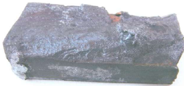
Figura 10: Outra face fraturada da amostra indicando a presença de "beachmarks"
