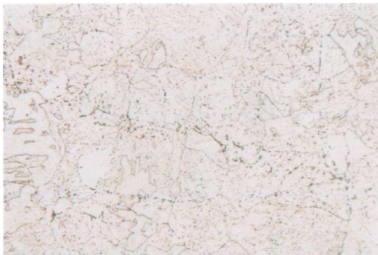
Figura 7: Material base da amostra apresentando carbonetos finos distribuídos na matriz. Aumento de 500x Fonte: Setor de inspeção da Indústria Petroquímica
