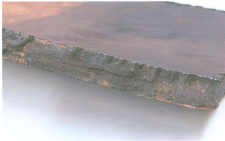
Figura 9: Detalhe da face de uma das fraturas, indicando uma linha próxima ao centro revelando o encontro das trincas internas e externas
