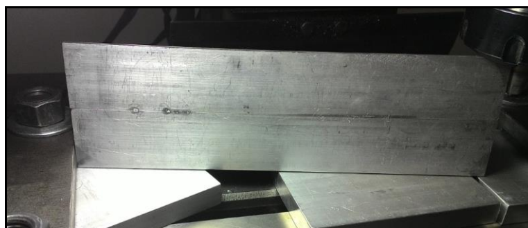
Figura 14. Raiz obtida após soldagem dos corpos-de-prova utilizando ferramental cônico em aço SAE 52100
