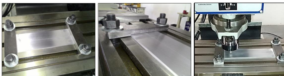
Figura 8. Preparação dos corpos-de-prova para os ensaios
