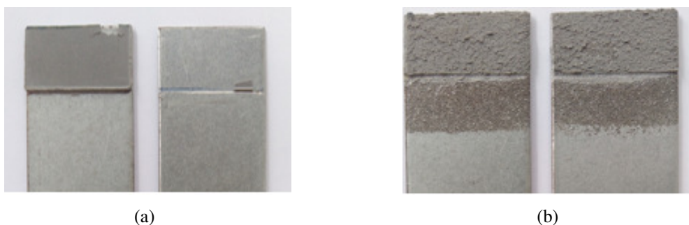
Figura 5- Superfície das juntas fraturadas (a) fratura utilizando placa metálica sem tratamento mecânico fratura adesiva e (b) fratura utilizando placa metálica com tratamento mecânico fratura coesiva.
