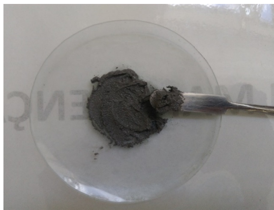
Figura 3 - Mistura do compósito de matriz epóxi com 20% de Al em volume.
