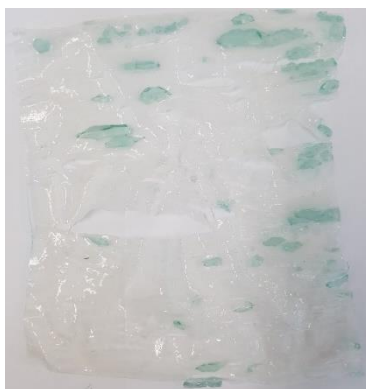
Figura 3. Filme de PVB de um corpo de prova com fragmentos remanescentes.
