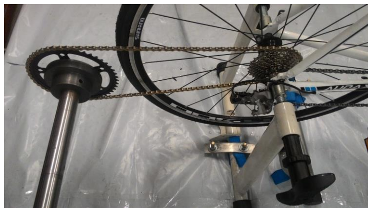
Figura 6. Conjunto de engrenagens para transmissão de potência entre a bicicleta e o eixo com torque resistivo.
