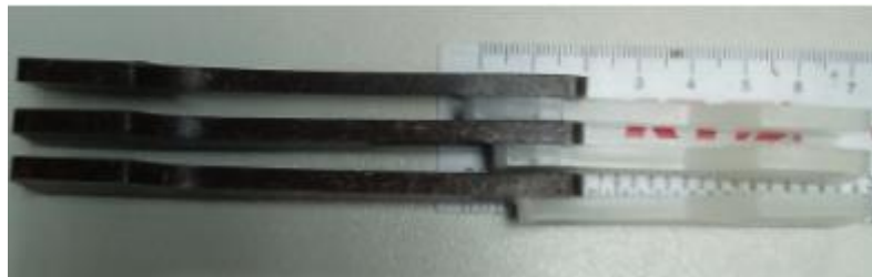
Figura 3: Corpos de prova com os diferentes overlaps .
