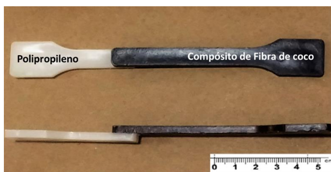
Figura 1. Corpos de prova injetados com overlap de 120mm 2 com materiais similares e dissimilares (vista lateral e frontal de materiais dissimilares).
