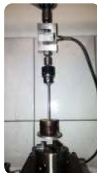
Figura 3. Montagem do aparato para a calibração da célula de carga com a utilização de massas conhecidas
