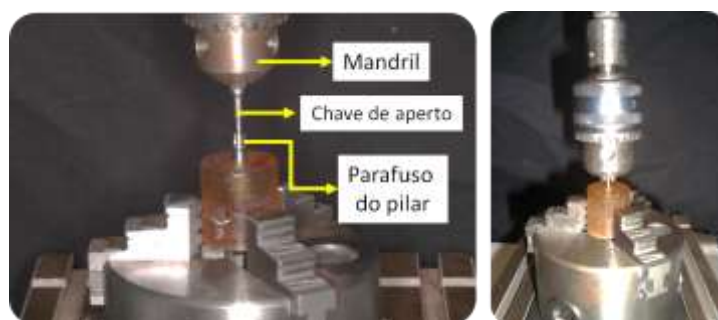
Figura 4. Posicionamento da amostra para aplicação de torque à esquerda e posicionamento para teste de força de arrancamento após remoção do parafuso do pilar à direita
