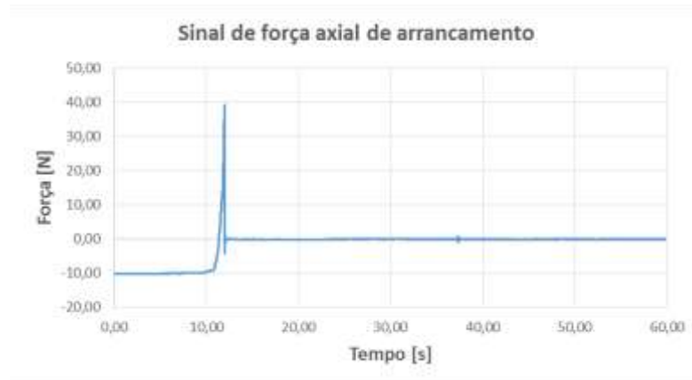
Figura 7. Comportamento do sinal de força axial no teste de arrancamento do pilar
