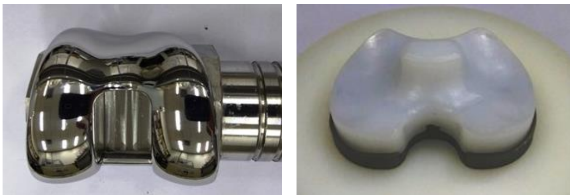
Figura 1. Componente femoral fixo com cimento no suporte metálico do equipamento, e inserto tibial montado por press-fit no platô tibial fixo com cimento no suporte polimérico do equipamento de ensaio.
