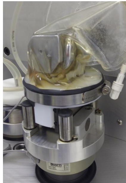
Figura 2. a) Montagem de ensaio segundo a ABNT NBR ISO 14242-3 e b) espécime montado para o ensaio.
