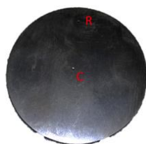
Figura 3. Posições de medição da dureza nos discos.
