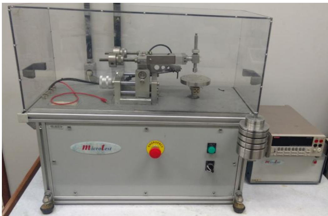
Figura 1. Tribômetro utilizado no experimento.
