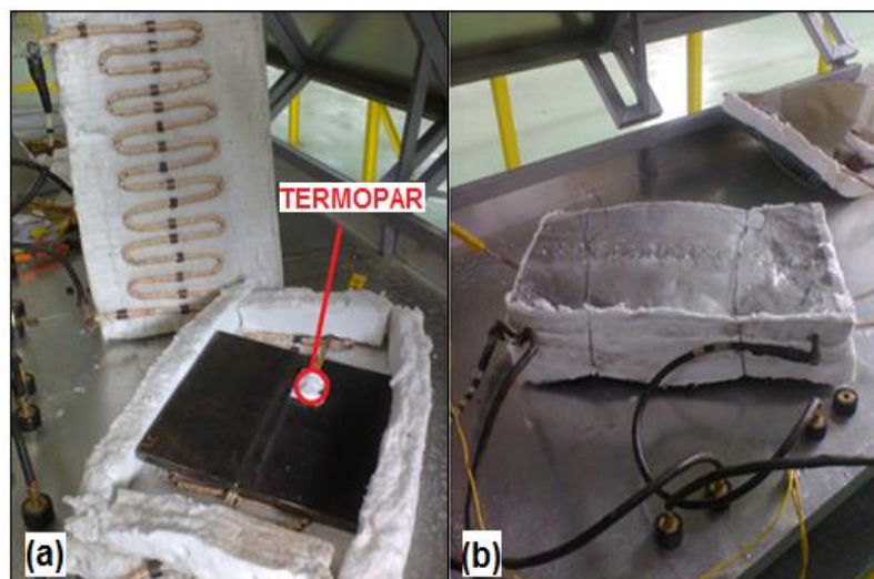
Figura 2 – Junta sendo tratada: (a) Preparação da peça na estufa e posicionamento termopar; (b) Estufa fechada com isolamento térmico de lã de vidro.
