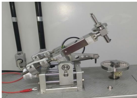
Figura 1. Tribômetro Micro Test MT/60/Ni.
