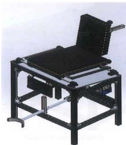
Figura 2: Modelo paramétrico para aferir força isométrica - TopSolid®
