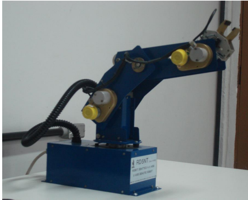
Figura 1. Robô manipulador de cinco graus de liberdade (5 GDL).
